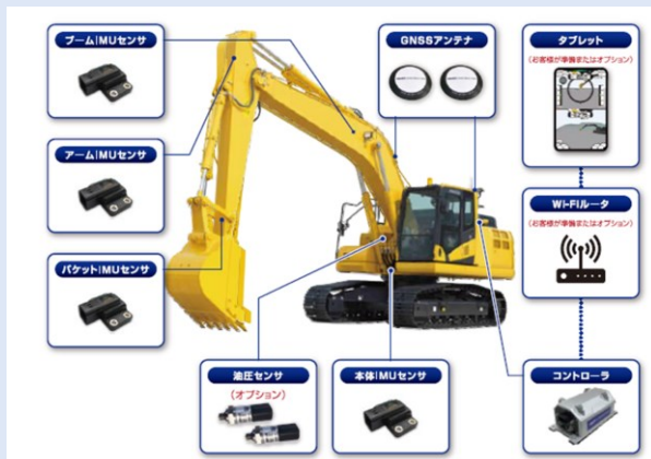
機器構成イメージ (GNSSアンテナ、IMUセンサ等)
